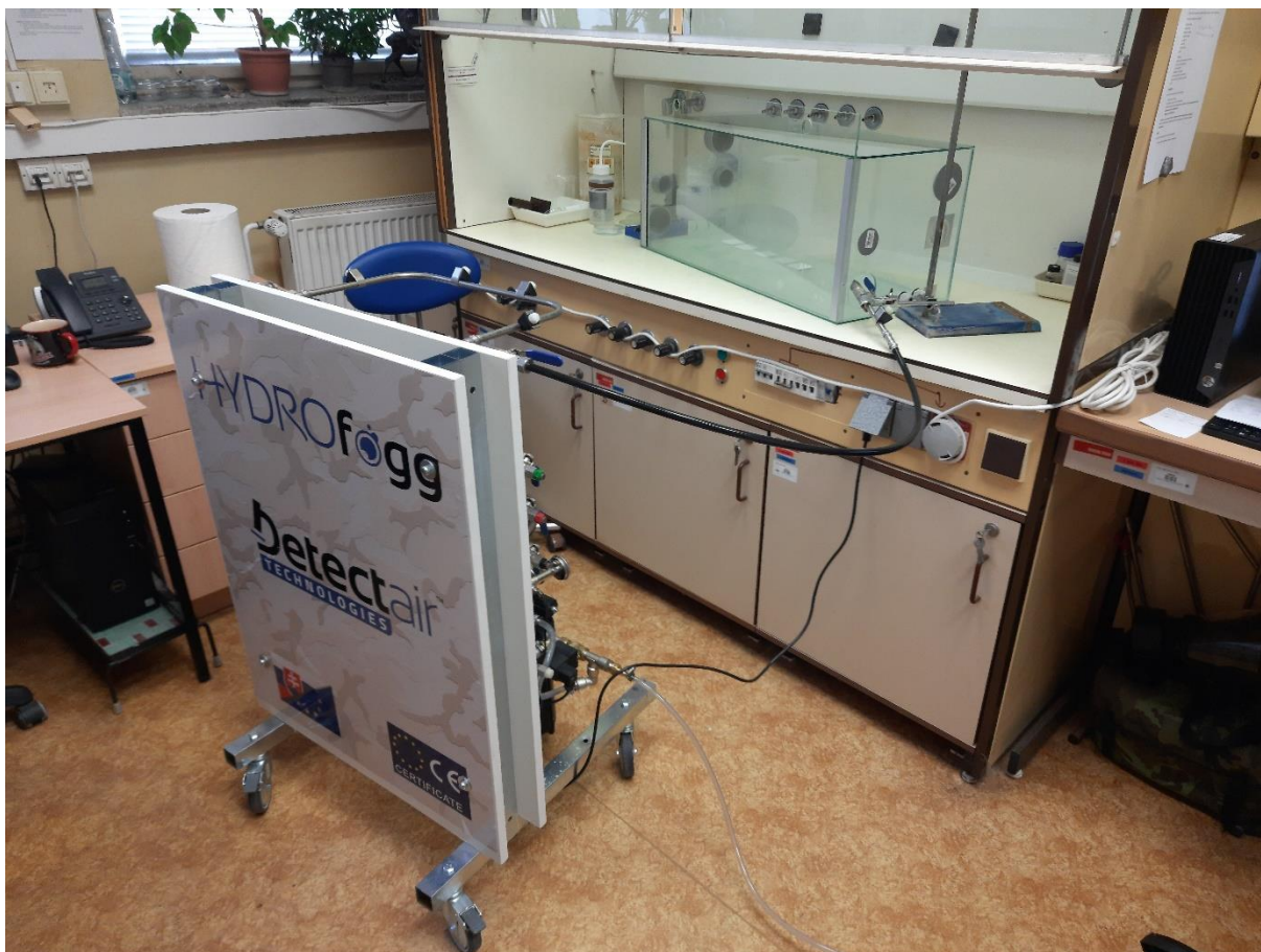
Obrázek 3 Zařízení HYDROfogg instalované do testovací komory
