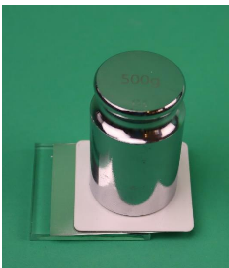
Obrázek 4 Vzorek se silikonovým přířezem a závažím
